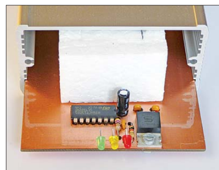
Bild 6: Modul mit Isolierung auf der Adapterplatine vor dem Einbau ins Gehäuse Fotos: DK3RED
