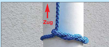
Bild 30: Der Zimmermannstek unterhalb des Schwerpunkts hält die Last.
