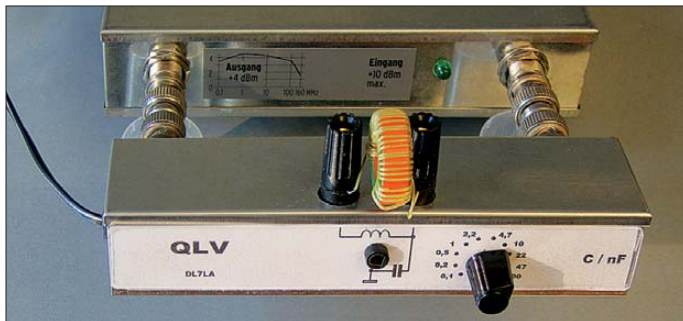
Bild 2: Eine HF-Experimentierplatine mit einseitiger Massefläche reicht bei Frequenzen bis 10 MHz völlig aus; der Platinenrand ist umlaufend mit dem Gehäuse verlötet.
