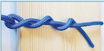
Bild 28: Wenn der Zimmermannstek belastet wird, bekneift sich das lose Ende.
