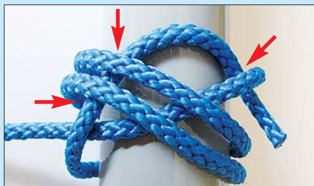
Bild 17: Das lose Ende des Seils ist dreimal unter die Wicklungen zu legen.
