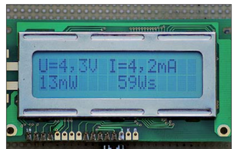
Bild 5: Anzeigebeispiel für eine Messung bei bewölktem Himmel; die vom Modul gelieferte Energie sinkt drastisch ab.
