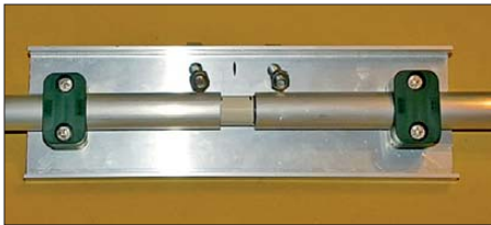
Bild 7: Mittelstück mit dem isoliert befestigten, aufgetrennten Rohr und den Schrauben der Masthalterung Fotos: DK7ZB
