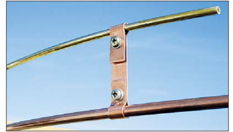
Bild 7: Die aus 0,8 mm dickem Kupferblech gebogene, verschiebbare Schelle zum Abgleich auf bestes SWW
