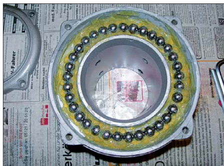
Bild 4: Neu gefettet und bestückt – fertig zum Zusammenbau
