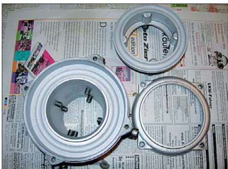
Bild 3: Zustand nach dem Säubern und Strahlen
