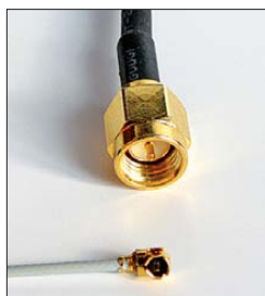
Bild 5: Ansicht des Steckverbinders in U.FL-Norm (unten) zur Montage auf der Modulunterseite im Größenvergleich mit einem SMA-Stecker
