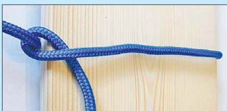
Bild 27: Beim Zimmermannstek ist das lose Ende zwischen Seil und Gegenstand durchgezogen.
