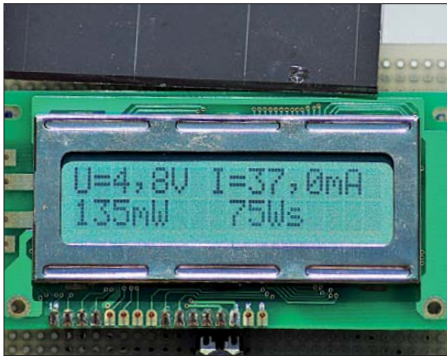
Bild 4: Anzeigebeispiel für eine Messung in der Mittagssonne, links unten die berechnete Leistung, rechts unten die erfasste elektrische Energie
