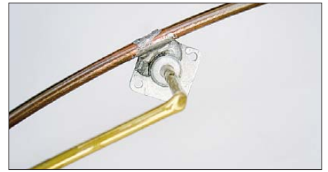
Bild 6: Die Koaxialbuchse ist genau an der Strahlerhälfte mit einer Ecke ihres Flanschs auf das 6-mm-Kupferrohr gelötet. Das 4-mm-Messingrohr führt im Abstand von 40 mm (lichte Weite) parallel zum Strahler.
