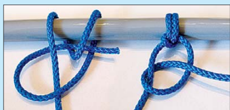
Bild 24: Für den Roringstek das Seil zweimal um die Leitung legen und dann das lose Ende durchstecken. Der halbe Schlag (rechts) nach dem Festziehen sichert den Stek.
