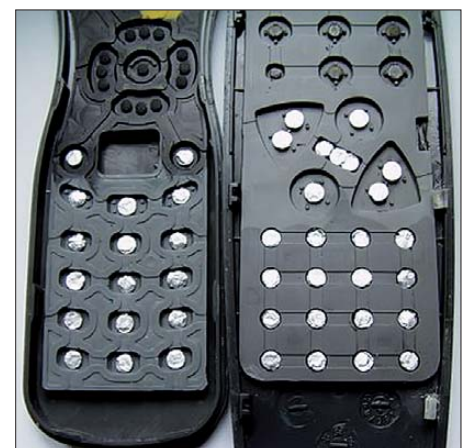
Geöffnete Fernbedienung, die mit Aluminiumplättchen repariert wurde Foto: Stephan
