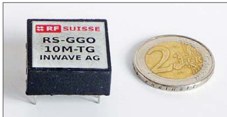
Bild 1: Das Frequenznormal RS-GGO10M-TG ist kaum größer als eine 2-€-Münze.
